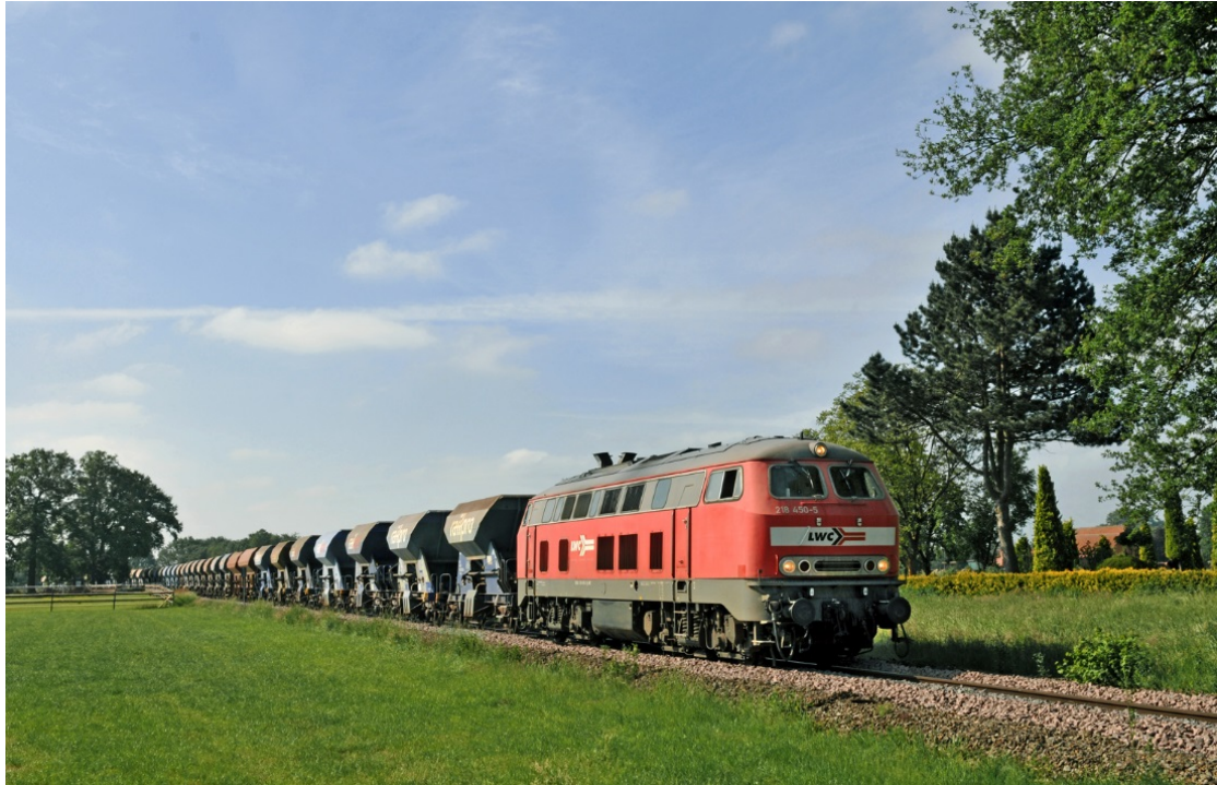
Vierzig Wagen westwärts! Genau 40 Schüttgutwagen hat die Diesellok der Lappwaldbahn Cargo GmbH am Zughaken. Der geladene Schotter reicht für gut einen Kilometer Strecke.
