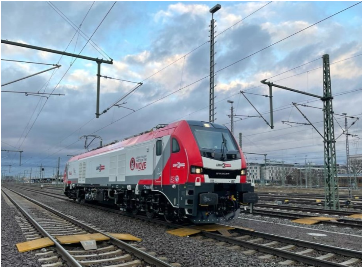
Frisch ausgelieferte Zweikraftlokomotive vom Typ „EuroDual“ der Lappwaldbahn Cargo GmbH (LWC)
